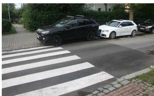
Opatření u přechodu pro chodce, kde parkovala vozidla oboustranně tak, že nebyly zajištěny potřebné rozhledy pro přecházení; vlevo původní, vpravo nová situace (ZŠ Solidarita, Praha 10)
